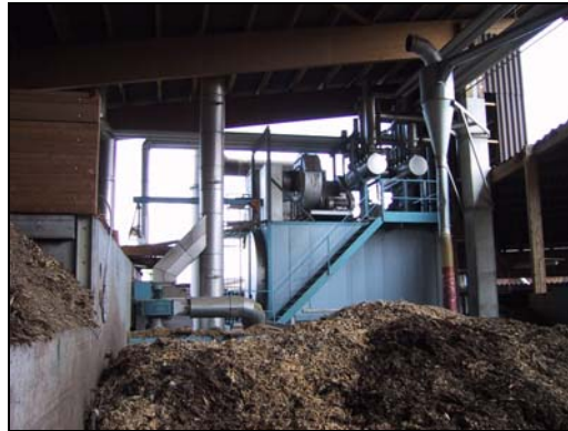
Abbildung 2.24: Verbrannt werden Schnitzel, Rinden- und Holzabfälle.
