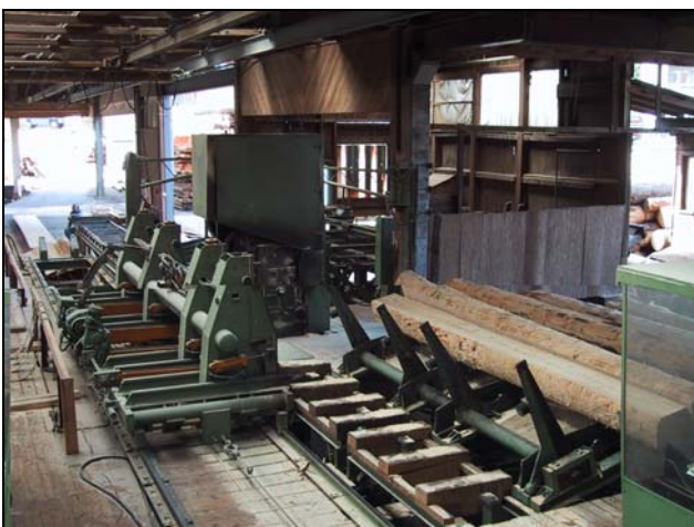
Abbildung 2.7: Blockbandsäge für Stämme bis zu einem Meter Durchmesser
