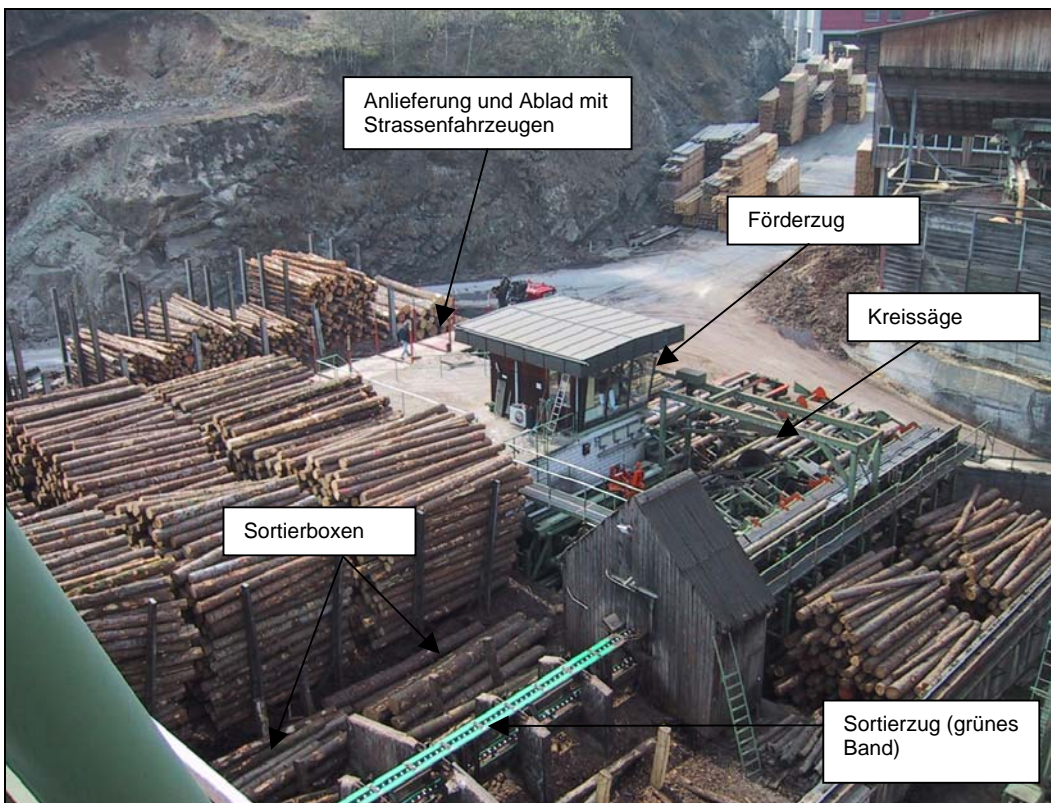
Abbildung 2.1: Rundholzplatz 2 mit Anlieferung. Hauptantrieb Kreissäge Leistung 45 kW. Das grüne Band ist der Sortierzug. Vom Sortierzug gelangen die Stämme in die Sortierboxen. Antriebe für Sortierzug: 26 / 33 kW.
