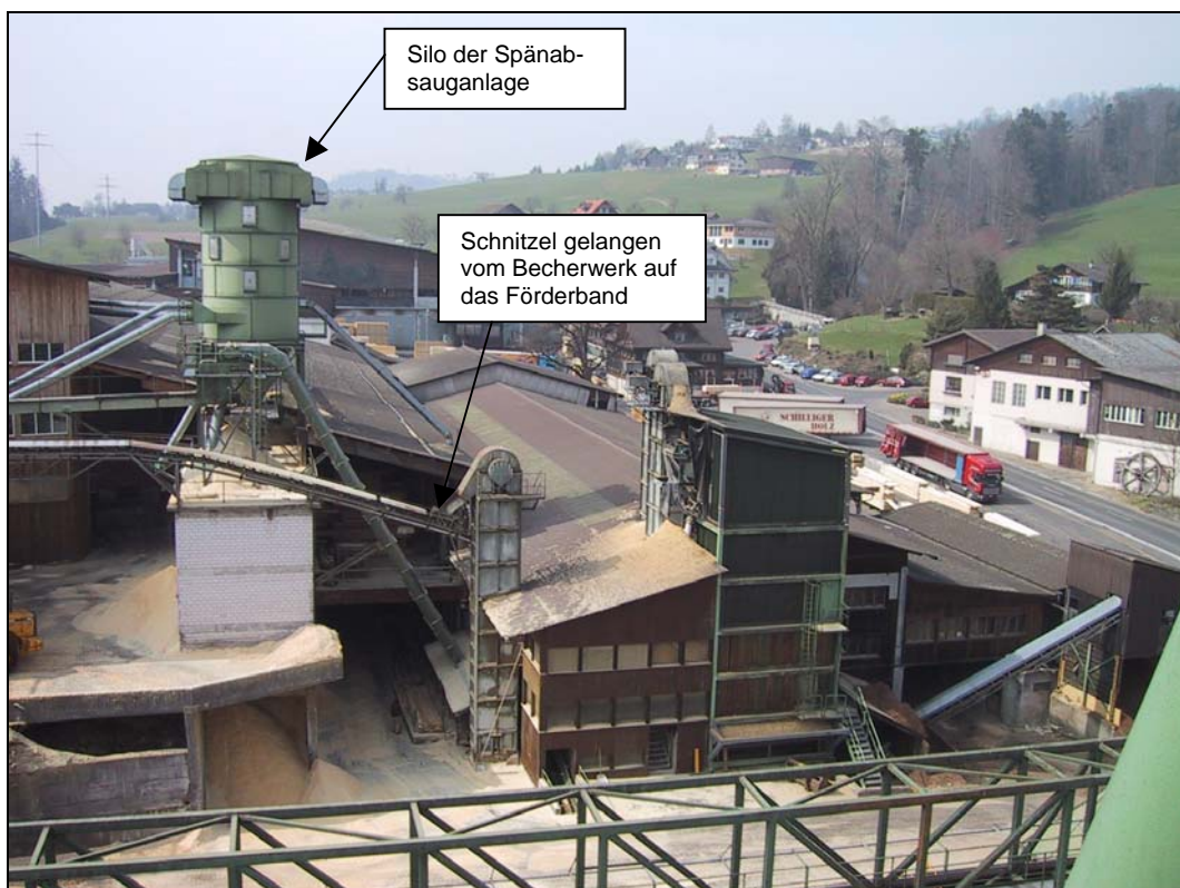
Abbildung 2.11: Die Entsorgung der Späne und Schnitzel hat eine zentrale Bedeutung: Fällt die Entsorgung aus, kann nicht mehr produziert werden.
