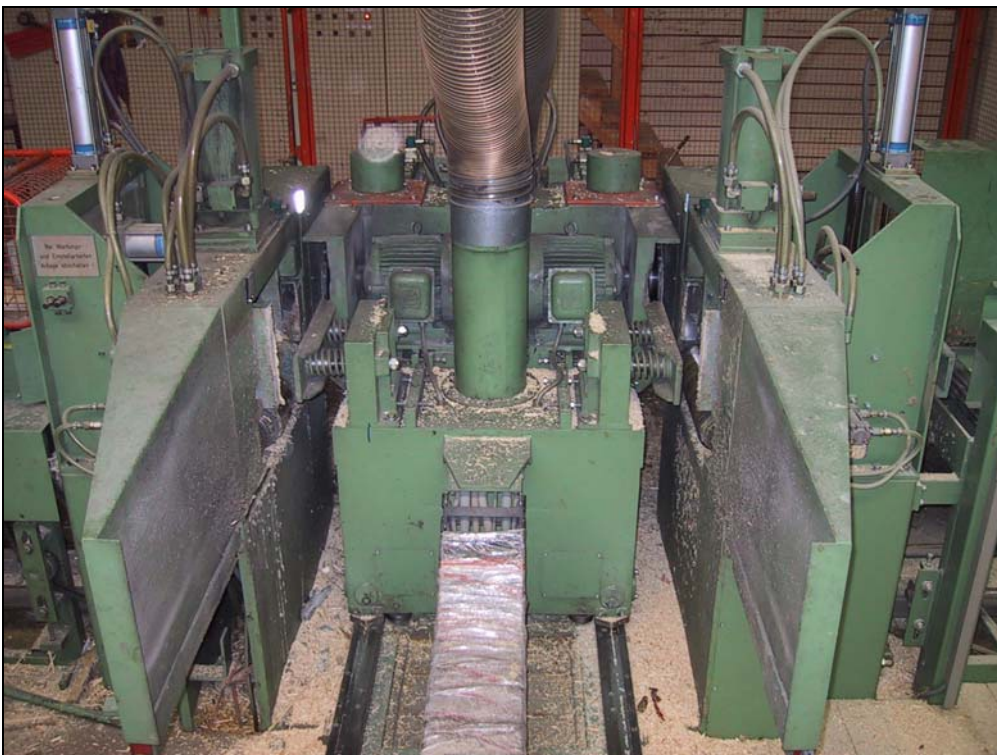
Abbildung 3.15: Keilzinkenanlage mit den beiden Zerspanermotoren. Die beiden Zinkenmotoren sind im Gehäuse unten eingebaut und im Bild nicht sichtbar.
