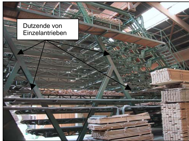
Abbildung 2.13: Sortierwerk Springer Leistung pro Motor ca. 3kW
