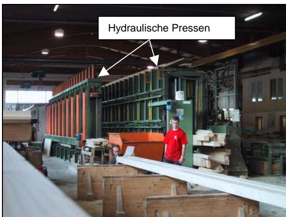
Abbildung 2.14: Leimwerk 1. In grossen hydraulischen Pressen werden die geleimten Einzelteile zu grossen Stücken zusammengefügt.
