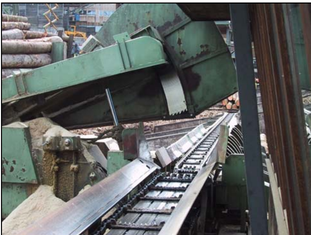
Abbildung 2.2: Rundholzplatz 1. Kreissäge bei Anlieferung. Hauptantrieb Kreissäge 37 kW.
