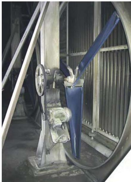
Ventilatoren in den Trockenkammern: Drehzahlregulierung spart 24 % Energie.
