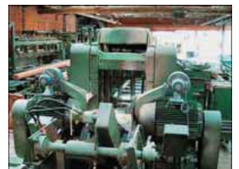
Motoren laufen häufig im Leerlauf. Ein bedarfsabhängiges Schalten lohnt sich.
